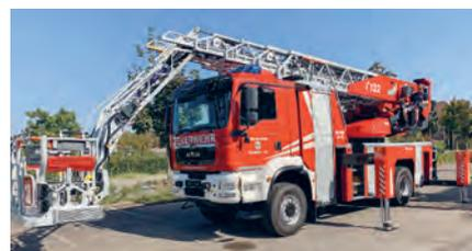
Die Drehleiter dient uns in erster Linie zur Personenrettung aus Höhen und Tiefen und zur Brandbekämpfung. Außerdem können wir eine Einsatzstelle durch die erhöhte Position hervorragend ausleuchten und auch geringe Lasten heben. Durch eine Arbeitshöhe von 32 Metern und den sogenannten Beugearm haben wir mit dieser Drehleiter nicht nur ein hochmodernes Fahrzeug bekommen, sondern erreichen auch Bereiche, welche mit unserer alten Drehleiter unvorstellbar waren.
